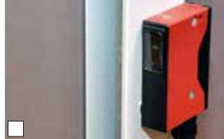
Lichtschranke unten zur Durchfahrtsicherung (Abb. GECCO)
