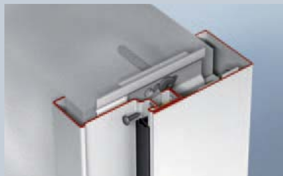
Gegenzargen-Profil 2 der Zarge durch die Dichtungsnut mit Profil 1 verschrauben und mit der Türdichtung überdecken
