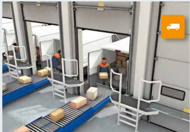
Die Transporter werden auf Hallenbodenniveau beladen. Dazu wird das Tor komplett inkl. Lamellensockel geöffnet
