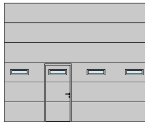
SPU F42, SPU 67 Thermo Lamellenfenster Typ D Schlupftüranordnung links
